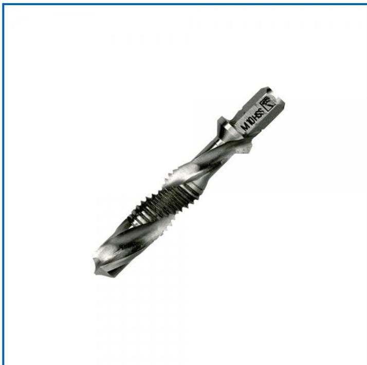
Forets tarauteur en acier rapide permettant de forer, de fileter et niveler des trous. L'épaisseur maximale du matériau est de 1x le diamètre de l'outil et dans des matériaux allant jusqu'à 6000N/mm<sup>2</sup>. Il est livré dans un coffret en plastique. Dispose d'une queue hexagonale.
